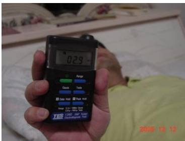
隔壁室內不當低壓環狀線圈 (臥室 2.9mG )
