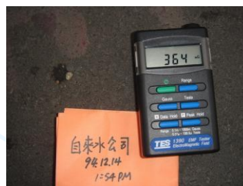
楊梅16萬伏特地下高壓電纜 路面364mG
