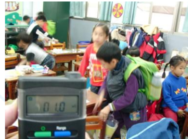
教室外高壓電纜 室內1.0mG
