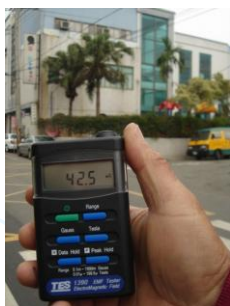
楊梅16萬伏特地下高壓電纜 路面42.5mG
